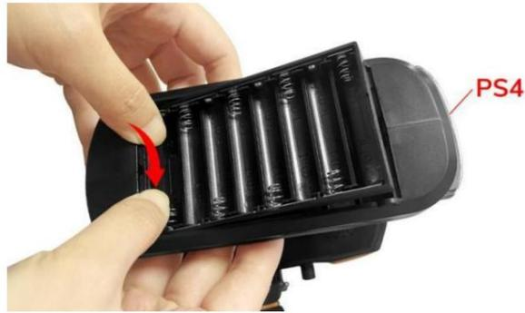
b. Utilisez une pince à épiler ou d'autres outils pour soulever une extrémité du boîtier de batterie vers le haut afin de retirer le boîtier de batterie.
