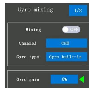
1) Gyroscope intégré : cela signifie que le gyroscope actuellement en fonctionnement est le gyroscope intégré du récepteur. Comment activer la fonction gyroscope du récepteur R8FG ? Veuillez vous référer à : [1.3.5 Fonction gyroscope de R8FG](#)
