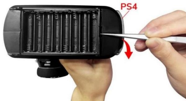
Si vous devez remettre le boîtier de batterie dans le bac à batterie, veuillez noter que l'encoche L'extrémité du boîtier de la batterie fait face à la direction du commutateur PS4.
