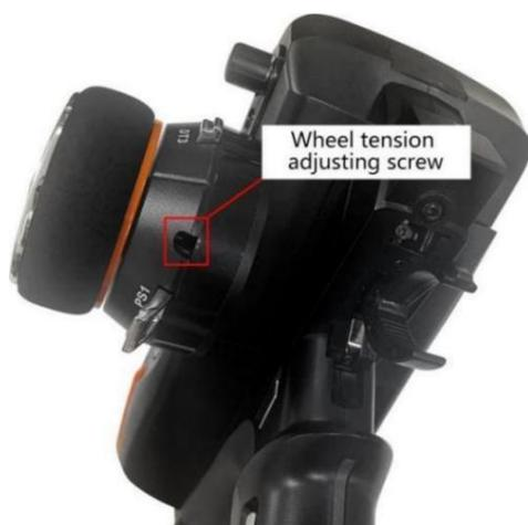
Étapes de réglage : À l'aide d'une clé hexagonale de 1,5 mm, desserrez la vis de tension de la gâchette (1,5 mm) de en le tournant légèrement dans le sens inverse des aiguilles d'une montre. Si la vis de tension de la gâchette est trop tournée, la vis peut tomber.
